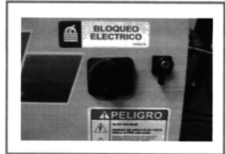
Fig. 22 Parte del tablero eléctrico, se observa el switch principal del paletizador (con su debido etiquetado de seguridad).
