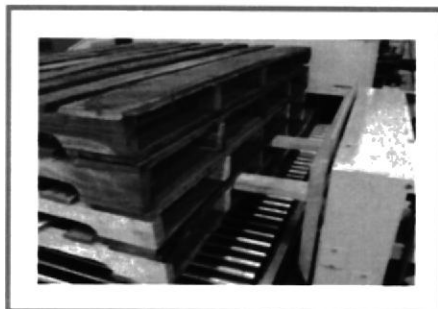
Fig. 26 Detalle de las horquillas cuando levantan la pila de pallets (desde el segundo pallet para que el primero pase al load máster por medio del conveyor).
