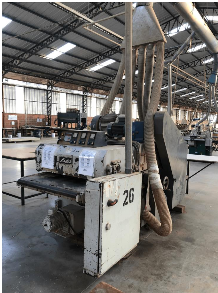
Ilustración 11: Maquinaria de Cepillo doble para madera
