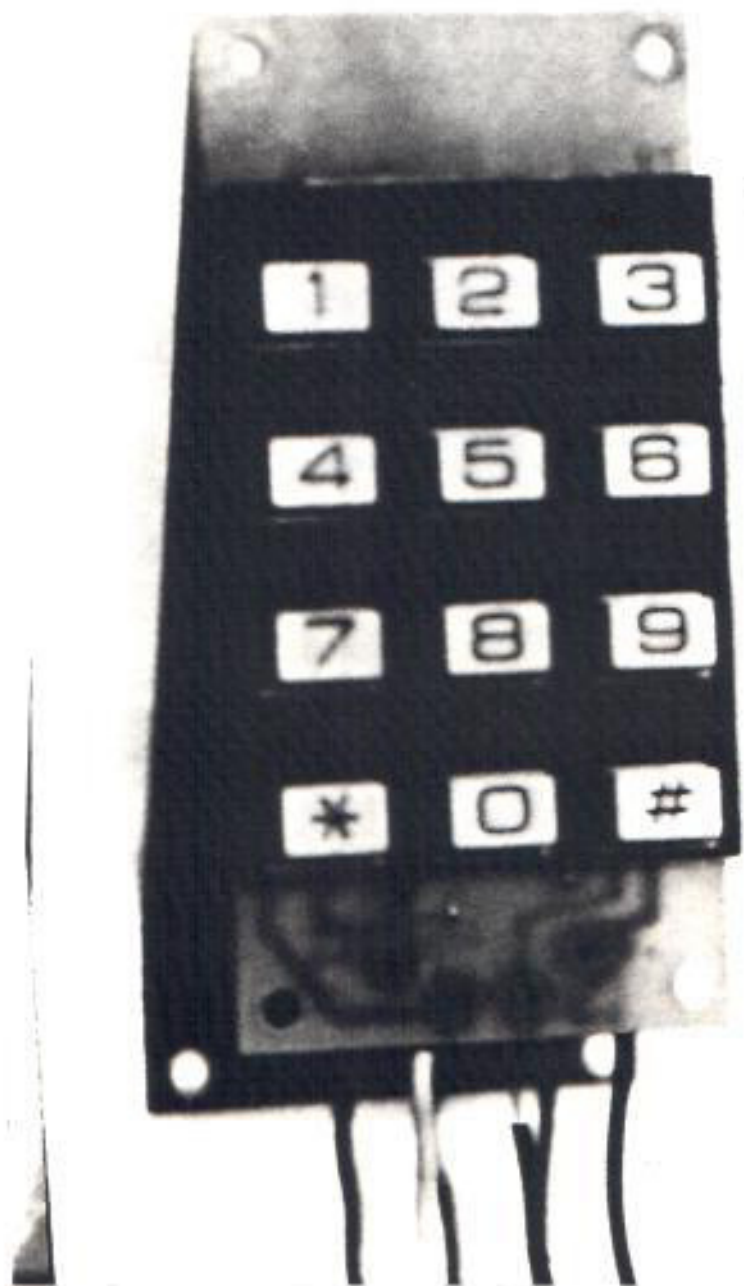
FOTO 5.1. VISTA SUPERIOR DEL SISTEMA DE SEÑALIZACION MULTIFRECUENCIA.
