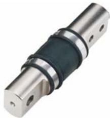
La celda empleada en el presente proyecto, LCDB 200 de la firma Omega, es de acero-niquelado con centro resistivo. Está protegida por una capa de neopreno y abrazaderas de acero inoxidable. Su capacidad de carga es de 200lb, una linealidad del 0.03% y una precisión de 0.037% a escala completa, lo cual entrega mediciones con un error mínimo. Su señal de salida tiene una resolución de 2 mV por voltio de excitación.
