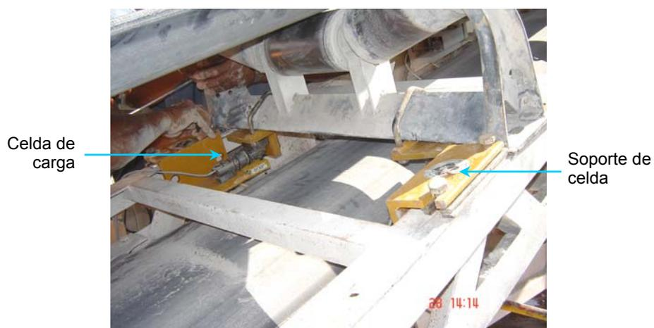
FIGURA 14.2. INSTALACIÓN DE BALANZA
