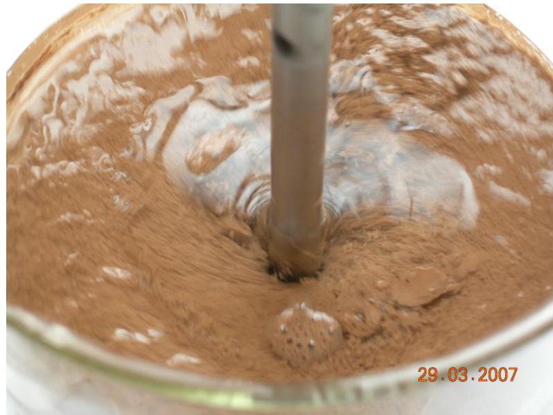
Fig. 4.9 Muestra de lodo con regulador de pH y Coagulante, Cristina Ballesteros, abr/ 07
