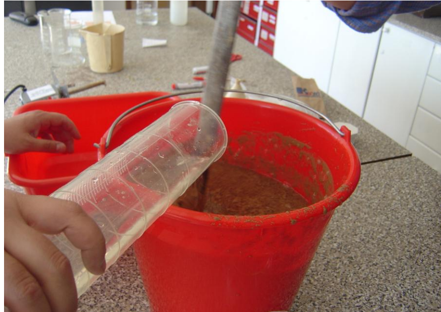
Fig.4.19 Adición de Regulador de pH a la muestra de lodo, Cristina Ballesteros, abril 2007
