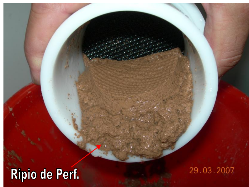
Fig. 4.16 Muestra de lodo acondicionada vaceada del Vaso-Geotubo de Prueba una vez que dreño el lixiviado, Cristina Ballesteros, abr/ 07
