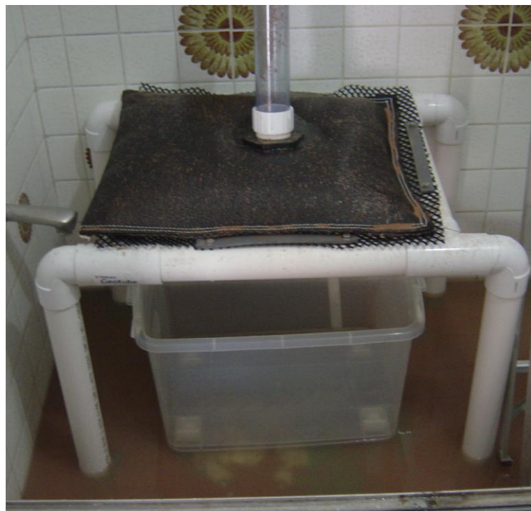
Fig.4.26 Bolsa GDT después de una hora de haber sido llenada con lodo acondicionado, Cristina Ballesteros, abril 2007
