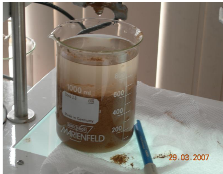
Fig. 4.13 y 4.14 Muestra de lodo con floculos totalmente sedimentados (acondicionado), Cristina Ballesteros, abril/ 07
