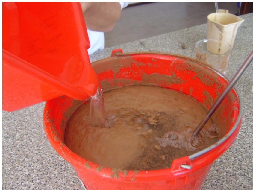
Fig.4.20 Adición de la mezcla (Coagulante, floculante 1 y floculante 2), Cristina Ballesteros, abril 2007
