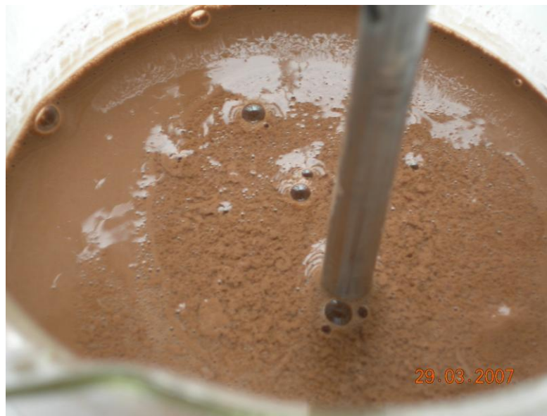
Fig. 4.8 Muestra de lodo con regulador de pH, Cristina Ballesteros, abr/ 07
