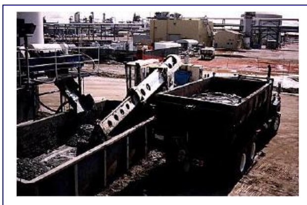
Fig. 1.5 Tanques de Metal para la colecta y almacenamiento temporal de Ripios de Perforación, fuente: Presentación “Waste Management”, Brandt, proporcionado en octubre 2006
