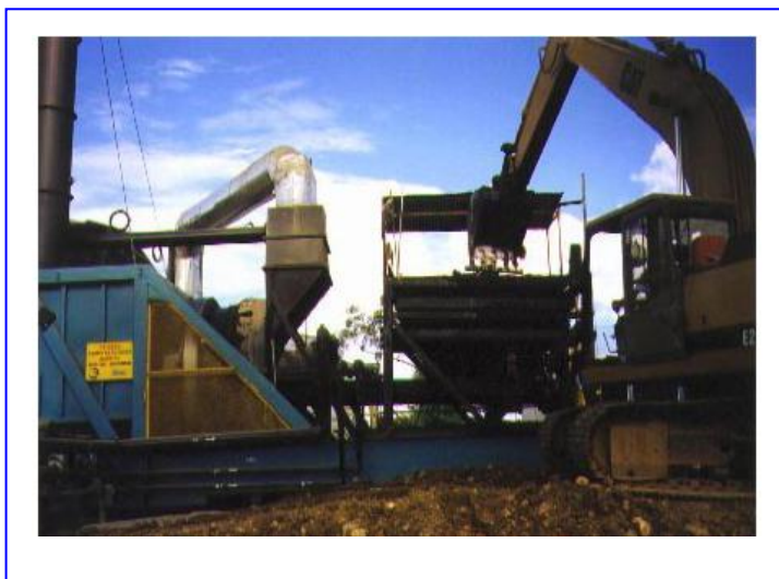
Fig3.10 Planta de Tratamiento Térmico, fuente: Presentación "Waste Management" de Brandt, proporcionado en octubre del 2006
