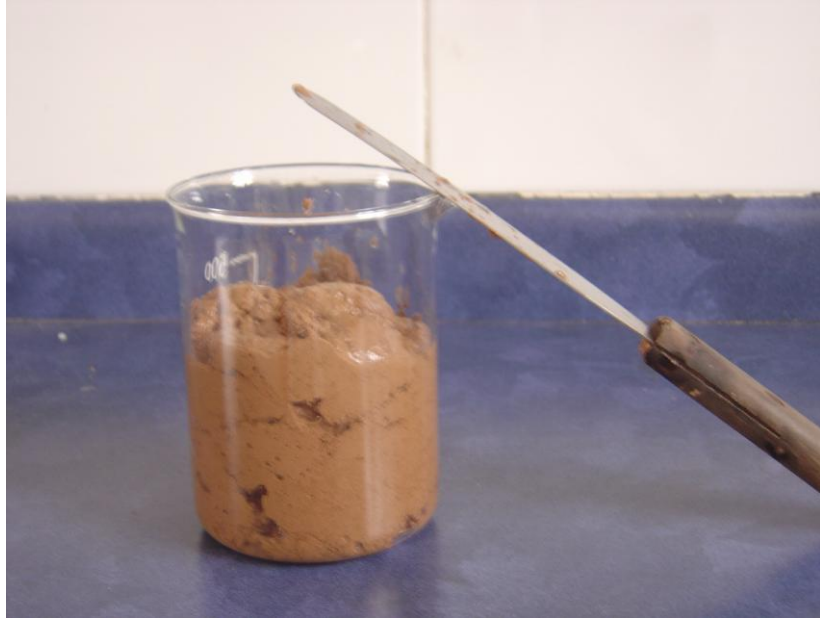
Fig.4.29 Ripio salido del geotubo a los 6 días (lucе mas húmedo que en la gráfica anterior), Cristina Ballesteros, abril 2007
