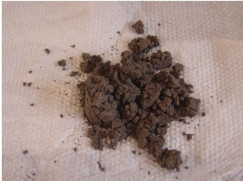
Fig.4.30 Sólidos, una vez realizada la Retorta, Cristina Ballesteros, abril 2007
