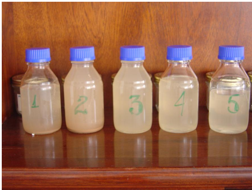
Fig. 4.27 Muestras de Lixiviado (agua drenada) tomadas cada media hora por dos horas, Cristina Ballesteros, abril 2007
