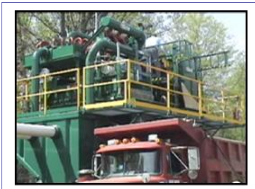
Fig.1.16 Limpiador de Lodo, fuente: Internet, mayo 2007
