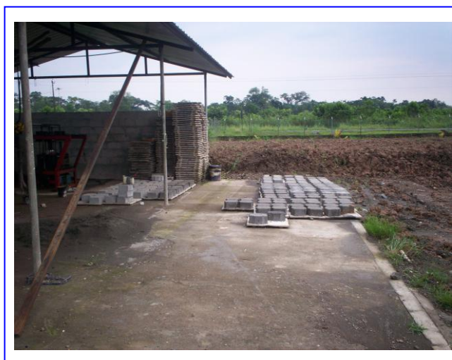
Fig.3.26 Reutilización del material Tratado en la elaboración de Adoquines, foto tomada en Cañón de los Monos en Coca, Cristina Ballesteros, mayo 2007
