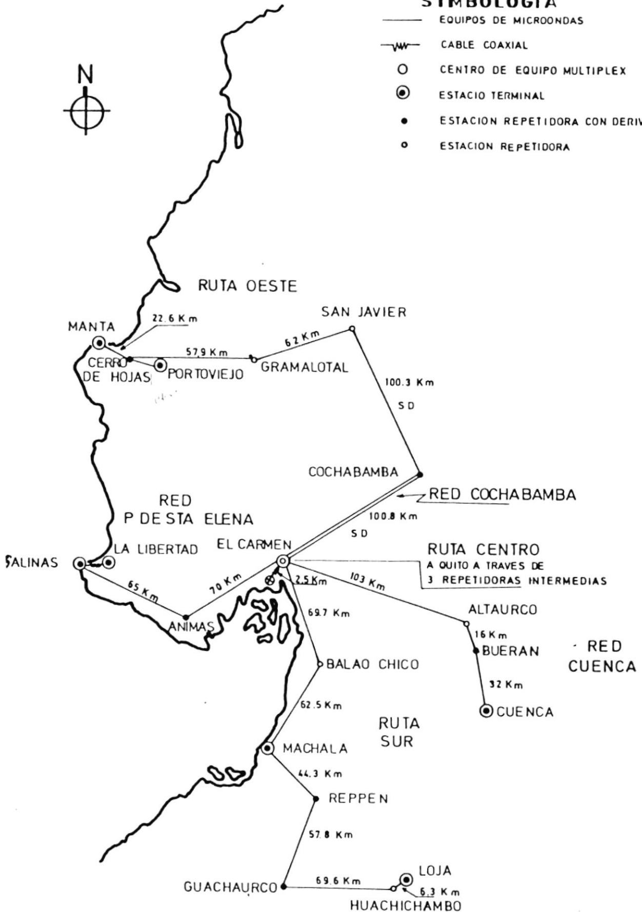
Fig. 17 SISTEMA DE MICROONDAS DE 300 Y 960 CANALES.
