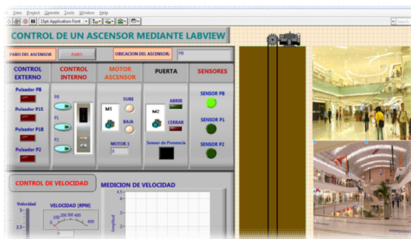
Figura 58.: Ascensor en PB en la Pantalla señala el indicador
