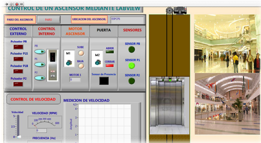
Figura 72.: Ascensor Cerrando Puertas P1.
