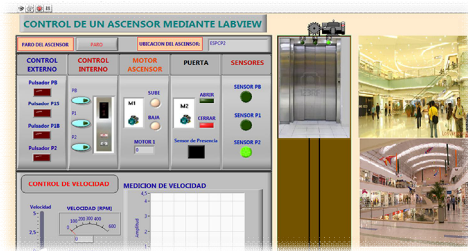
Figura 69.: Ascensor en P2 Cerrando Puertas
