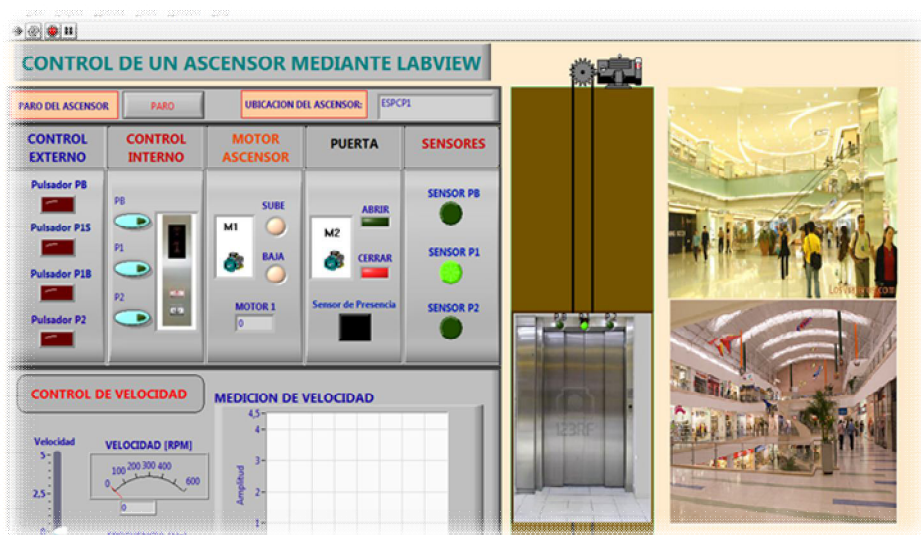
Figura 65.: Ascensor en P1 Cerrando Puertas
