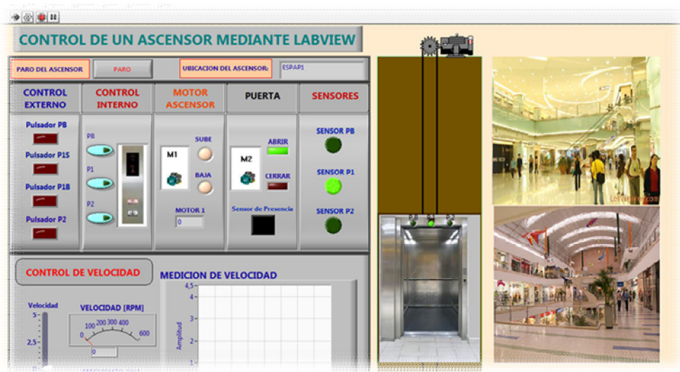
Figura 64.: Ascensor en P1 Abriendo Puertas
