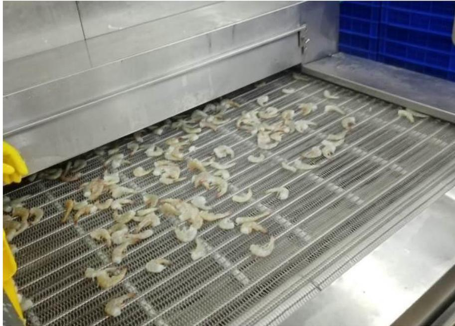
Ilustración 31. Túnel de Secado
