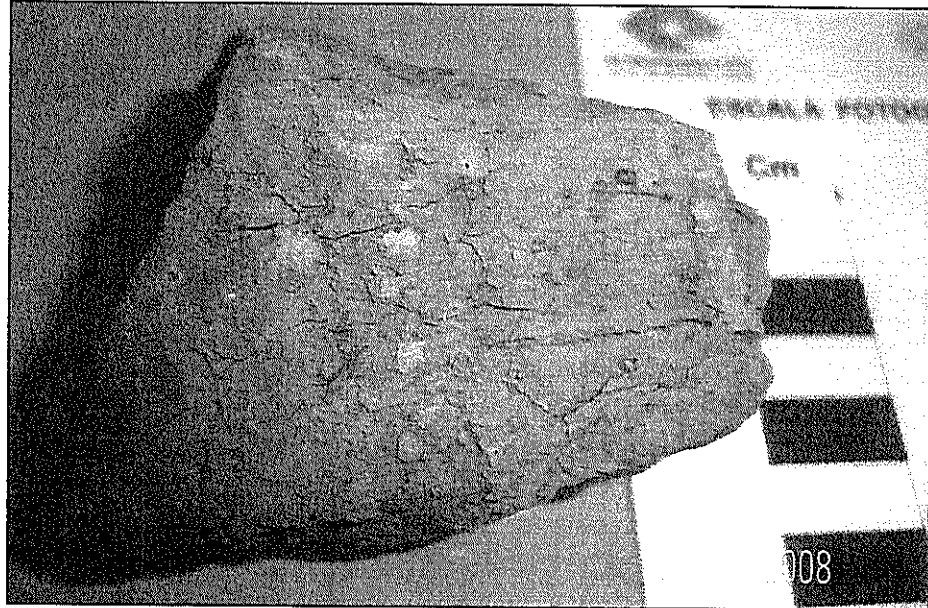
Figura. 4.40 Muestra DAMA-14, M01p. Lodolita homogénea, algo meteorizada. Fuente: Coello X., 2008
