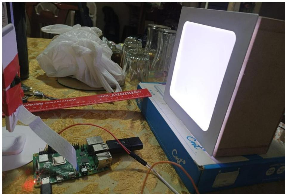
Figura 4. Toma de muestras del trasmisor OCC a 30cm.
