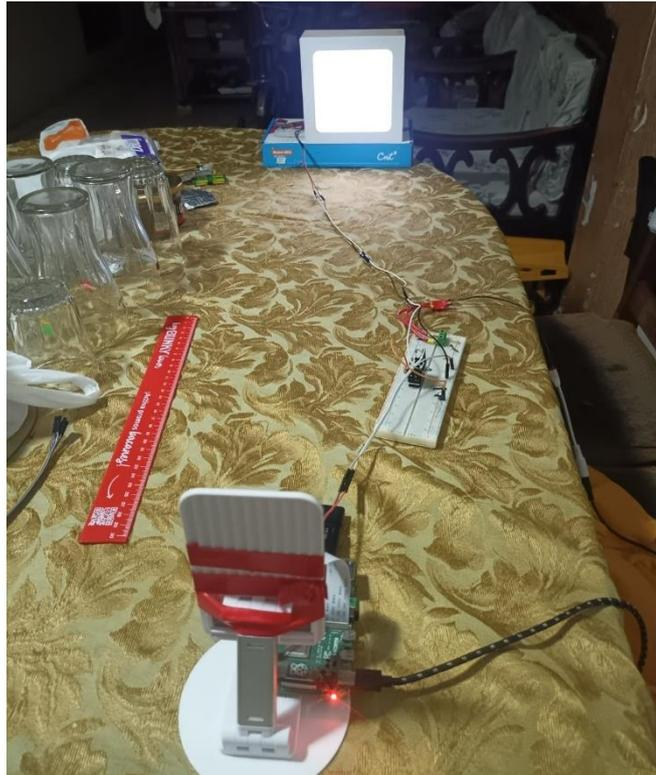
Figura 5. Toma de muestras del trasmisor OCC a 1 metro.
