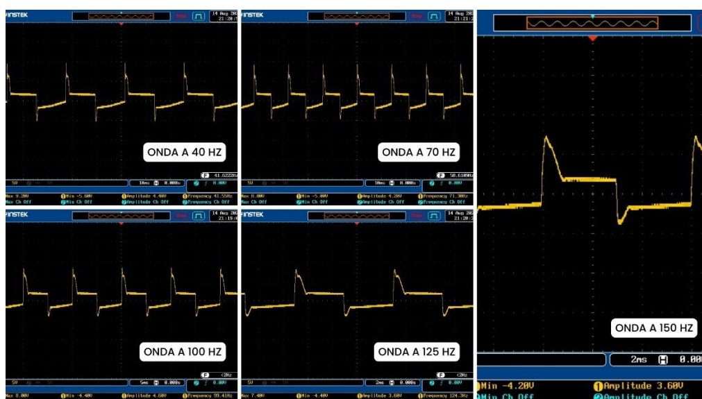
Fig.18. Electroestimulador diseñado. Ondas a distintos niveles de frecuencia.
