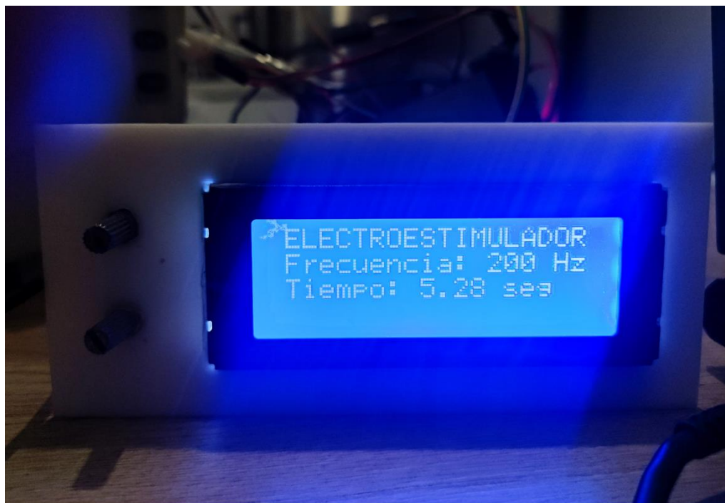
Fig.15(A). Electroestimulador generando 200 Hz de frecuencia.
