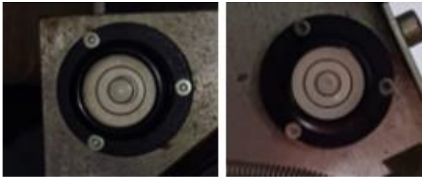
Figura 3.10 Nivel derecho e izquierdo respectivamente del Gantry (Fuente: Autor)
