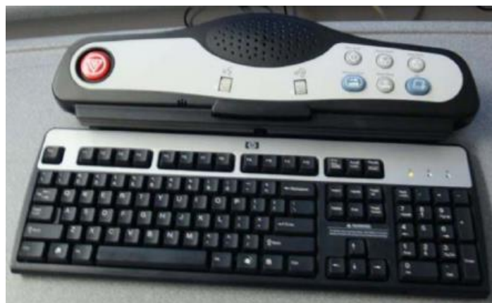
Figura 1.15 Módulo de Interfaz de Control de Escaneo (SCIM) (Fuente: Pre-Installation Manual 5368511-1EN)
