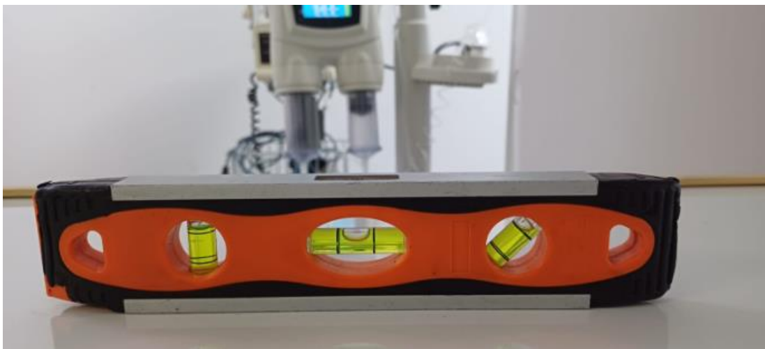
Figura 3.8 Nivel longitudinal de mesa y camilla (Fuente: Autor)
