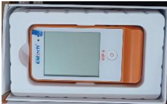
Figura 3.4 Medidor de temperatura y humedad (Fuente: Autor)
