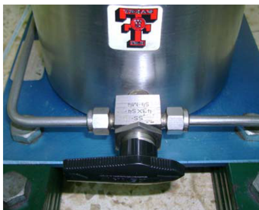
Fig. 3.15 Válvula de tres vías de la cámara de alta presión (Fuente: Colón López, Octubre 2007)
