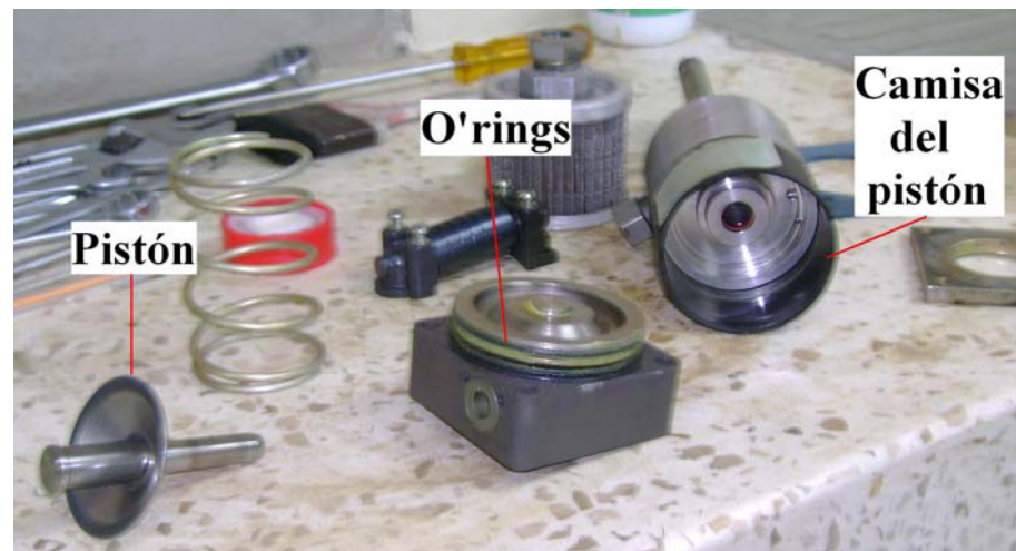
Fig. 3.26 Partes internas de la bomba (Fuente: Colón López, Septiembre 2007)
