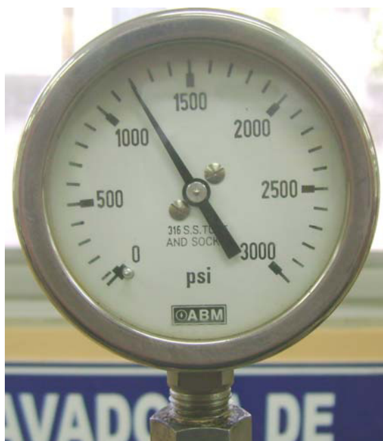
Fig. 3.10 Medidor de presión a 1200 psi (Fuente: Colón López, Octubre 2007)
