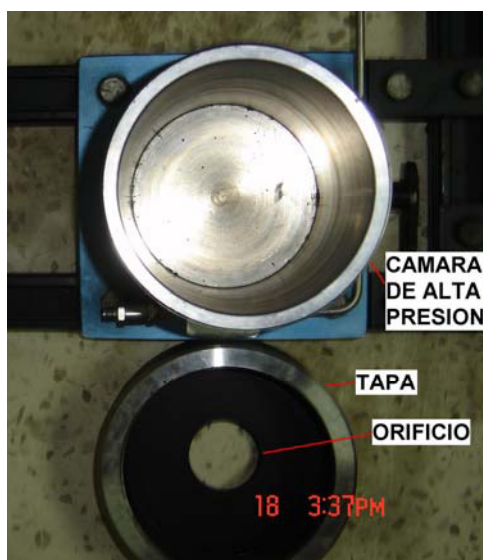
Fig. 3.2 Vista en planta de la cámara de alta presión (Fuente: Colón López, Junio 2007)
