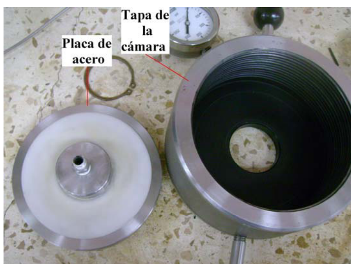
Fig. 3.3 Accesorios de la tapa de la cámara de alta presión (Fuente: Colón López, Agosto 2007)
