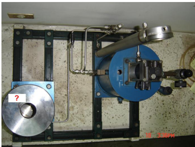
Fig. 1.3 Orificio encontrado en la tapa de la cámara de alta presión
