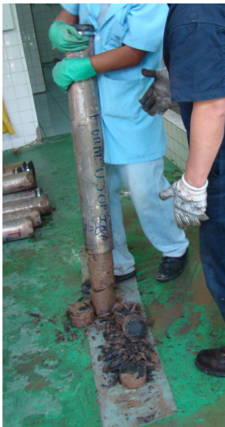
Fig. 2.2 Tubo de aluminio abierto y testigo aún con fluido de perforación
