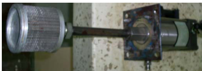
Fig. 3.9 Filtro de línea de succión de líquido de la bomba (Fuente: Colón López, Septiembre 2007)
