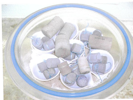
Fig. 4.4 Núcleos utilizados en pruebas preliminares (Fuente: Colón López, Octubre 2007)
