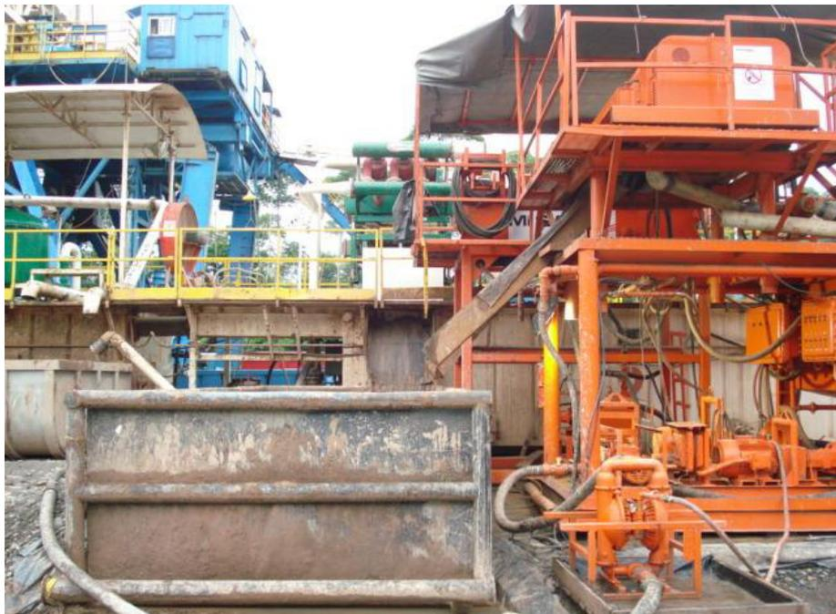
Grafico 3.10. Tanque de almacenamiento en el proceso de dewatering.
