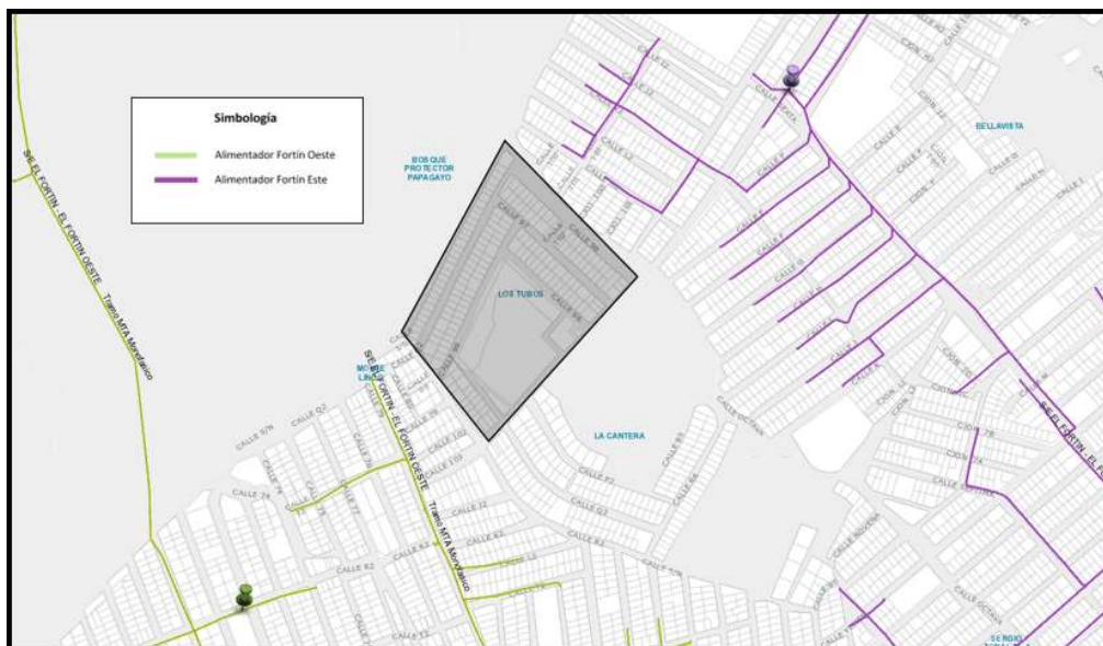
Imagen 11 Alimentadores en media tensión
