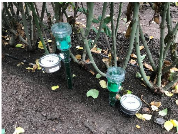
Figura 4 Medidores analógicos de humedad de suelo
