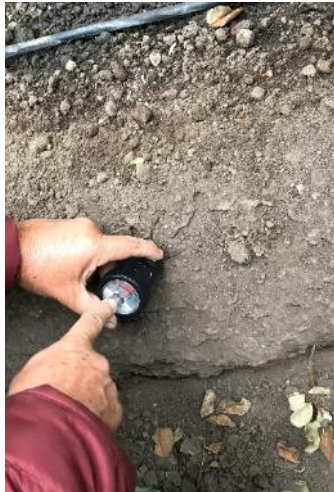
Figura 3 Medidor analógico de pH
