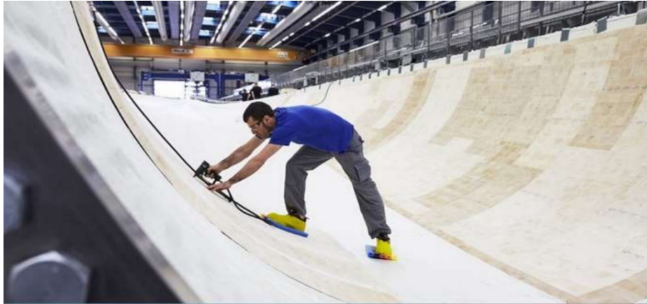
Figura 2. Láminas de Balsa en aspas de aerogeneradores.
