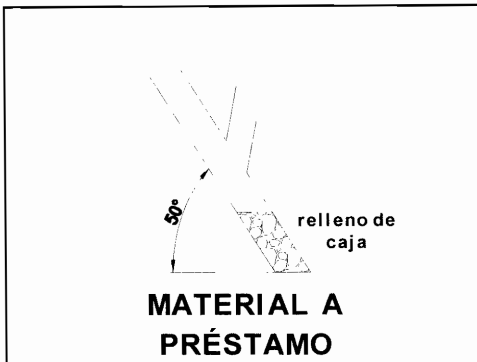
Fig. 25. Obtención del relleno desde la caja alta (Crespo J. 2007)
