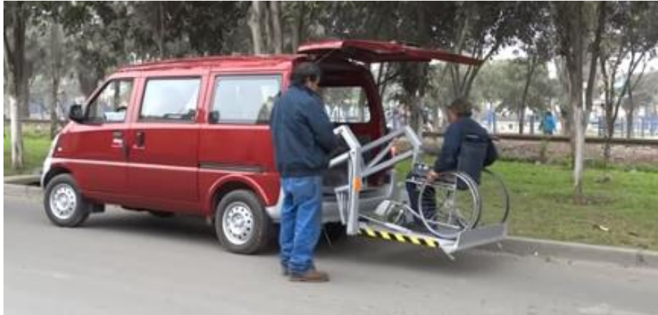
Figura 31 Rampa eléctrica automatizada
