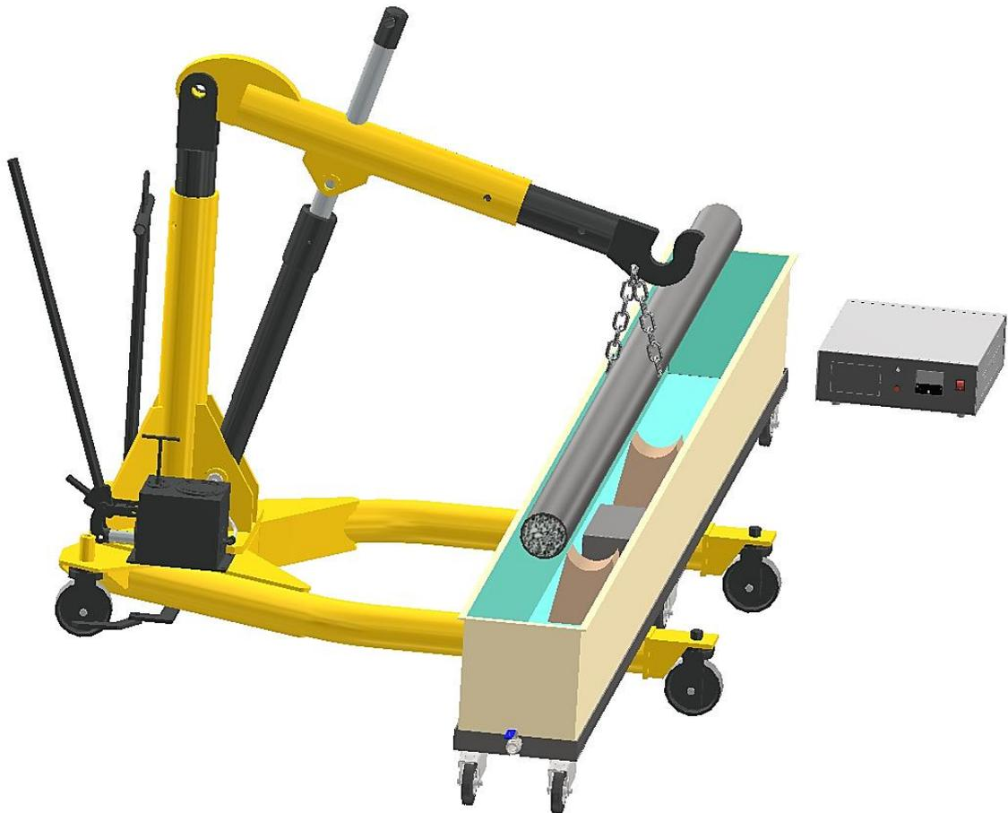
En el diseño presentado (Figura 3.9) se consideró un tubo obstruido para sumergir dentro del tanque de inmersión, esto para conseguir un proceso de limpieza ultrasónica eficiente a lo largo de la estructura de la tubería, es importante que el tanque contenga los litros de líquido limpiador suficientes para cubrir por completo el tubo y así haya disponibilidad del efecto de burbujeo por cavitación homogéneamente sin rebozar los 350 mm de la altura del tanque.
