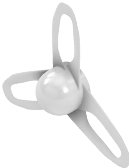
Figura 2.4. Hélice toroidal con ángulo de ataque 15° (Solución C)
