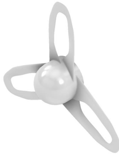
Figura 3.3. Vista isométrica de la hélice toroidal con ángulo de ataque de 15°
