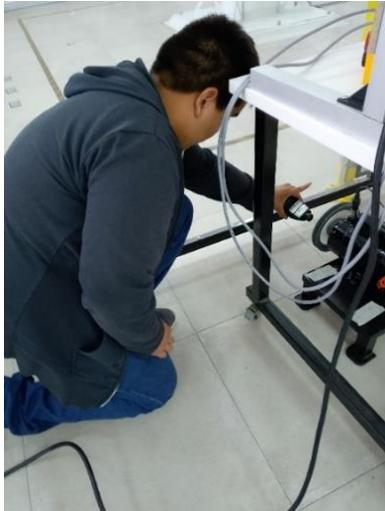
*Nota.* Verificación de la estabilidad en la velocidad del motor, crucial para analizar vibraciones y detectar con precisión el fallo en los rodamientos.
