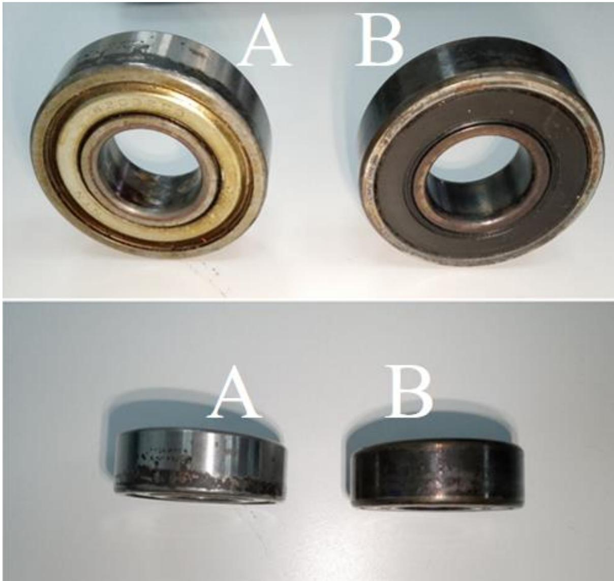
*Nota.* La imagen muestra dos rodamientos (A: primer rodamiento dañado, B: segundo rodamiento dañado) que presentan un deterioro caracterizado en las pistas de rodadura. Las carcasas exhiben corrosión y oxidación, producto de un ambiente de trabajo contaminado o falta de mantenimiento.
