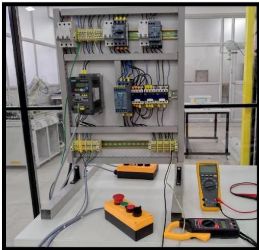
*Nota.* Muestra la configuración eléctrica del banco de pruebas, diseñada para conectar de manera segura el sistema a una fuente de alimentación de 220V monofásico.
