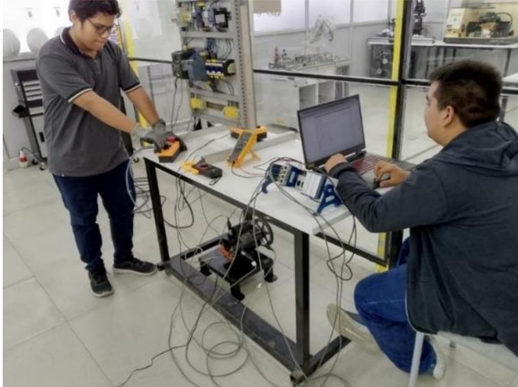
*Nota.* Ilustra el montaje experimental utilizado para demostrar la viabilidad del sistema diseñado para detectar fallos en rodamientos.
