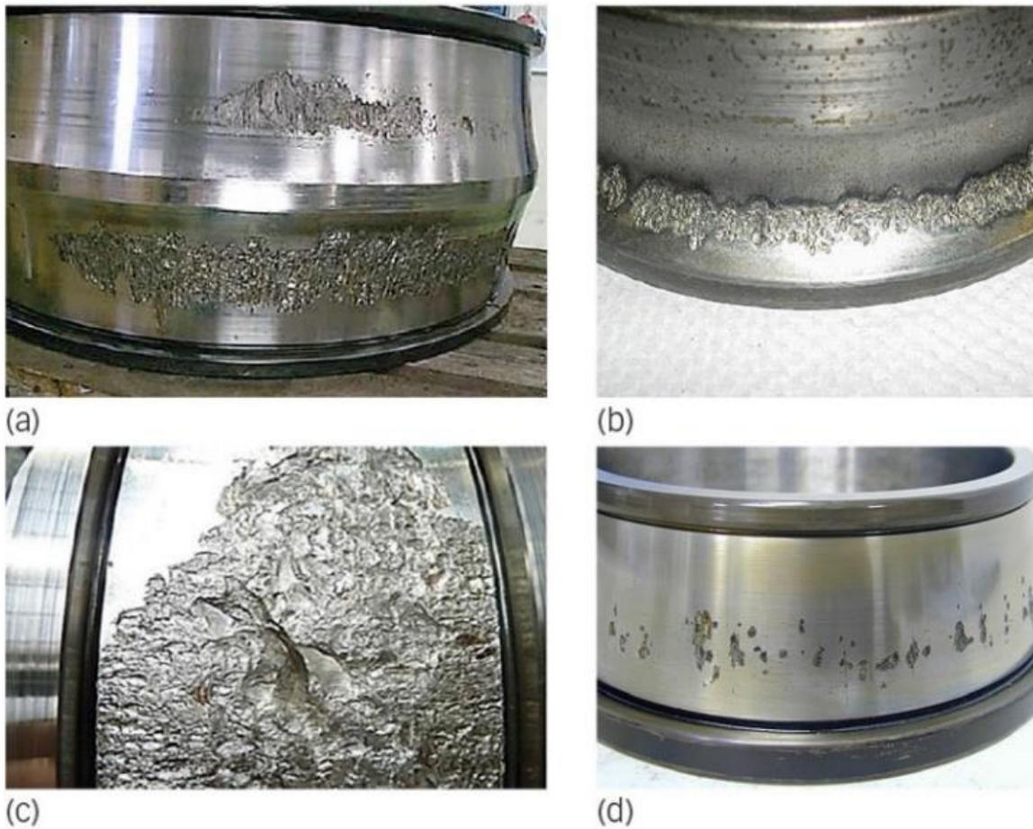
Nota: Corrosión blanca por ataque ácido producida por fatiga por contacto rodante, (a) maquinaria para papel, (b) compresores, (c) etapas de baja velocidad y (d) alta velocidad en cajas de engranajes de turbinas eólicas.
