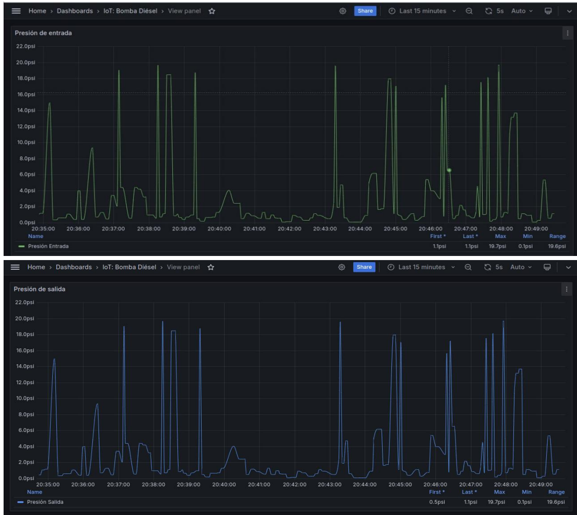
Figura 3.5 Datos medidos presión de entrada y salida
