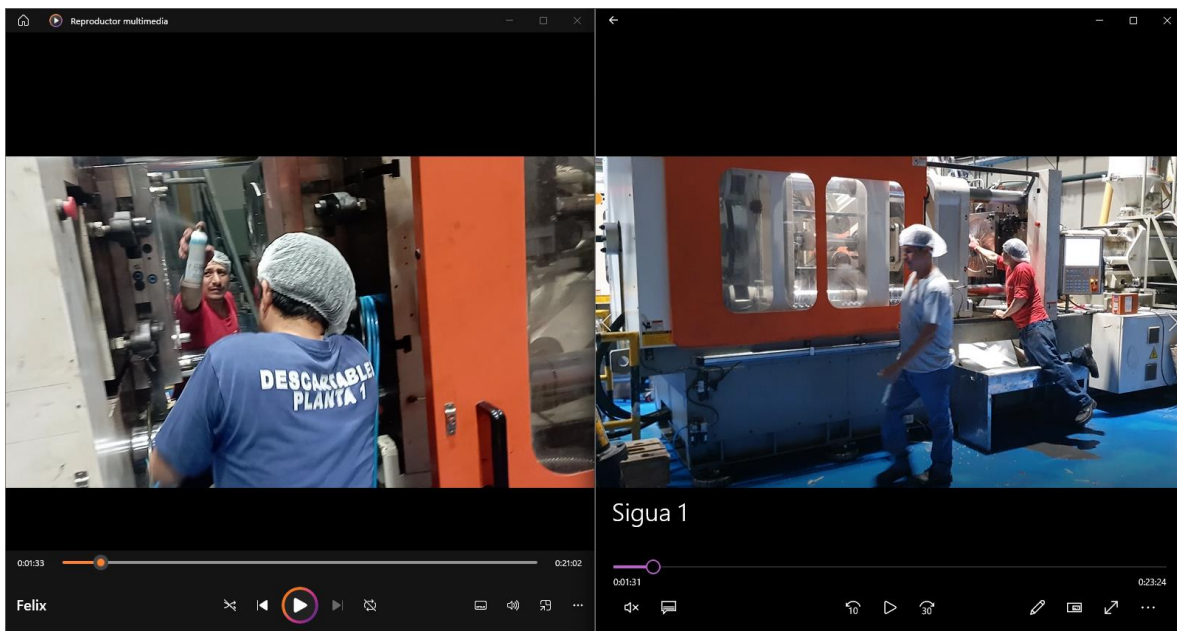
Figura 2.18 Retirar mangueras de circuito de refrigeración, colocación de desmoldante y limpieza de área
