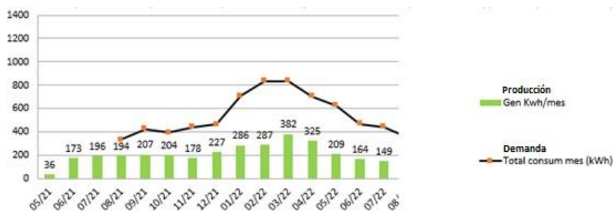
Fig. 1 Curva de producción (3kW) contra demanda mensual, desde mayo del 2021 hasta agosto del 2022.
