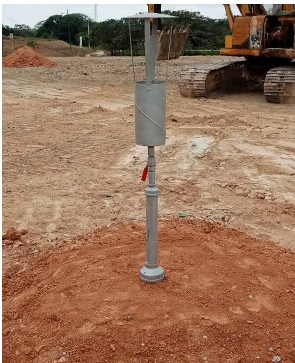
Foto 1. Incinerador de gas metano.
