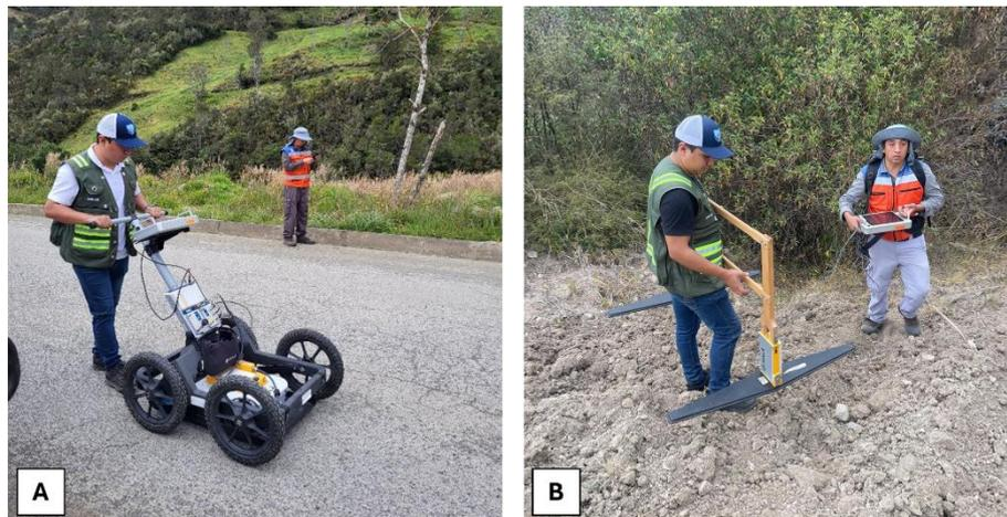
*Nota:* A) Antena blindada de 500 MHz y B) Antena no blindada de 200 MHz.
