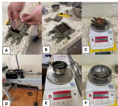
*Nota:* A) Caja de corte armada, B) Caja de corte con el material contenido, C) Pesaje de la caja con el material contenido, D) Equipo de consolidación y corte, E) Pesaje de la muestra húmeda y F) Pesaje de la muestra seca.
