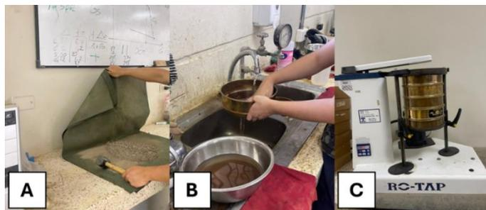
*Nota:* A) Disgregación de muestra con maso de goma, B) Lavado de muestra con el tamiz N.200 y C)
