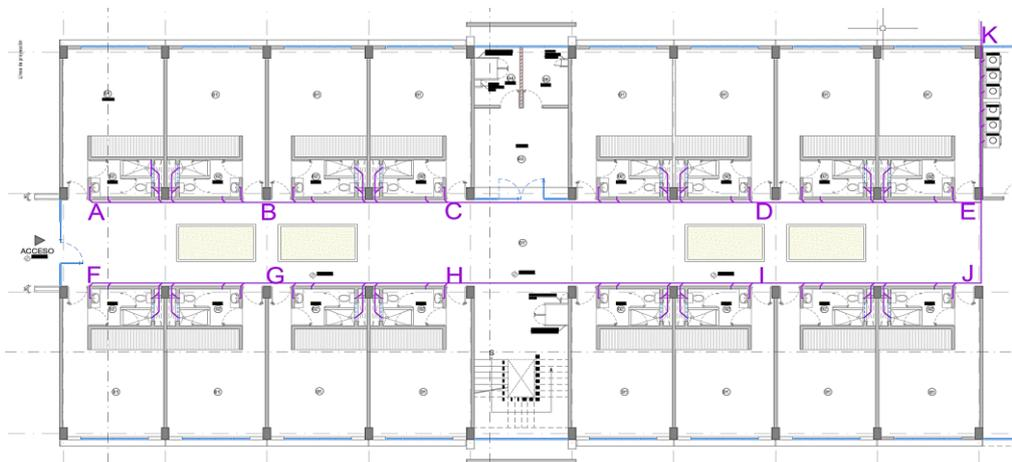
Los tramos del A al E y del F al J poseen una pendiente del 2% y de J a K posee un valor de 0.8%. Se procederá a analizar las tuberías horizontales en primer lugar. Es necesario determinar las unidades de descarga propias y acumuladas de cada tramo. Una vez que se haya establecido la unidad de descarga acumulada final para cada tubería principal que conducirá a la caja de registro, se utilizará la tabla siguiente para seleccionar el caudal (Q) correspondiente a esa cantidad.
