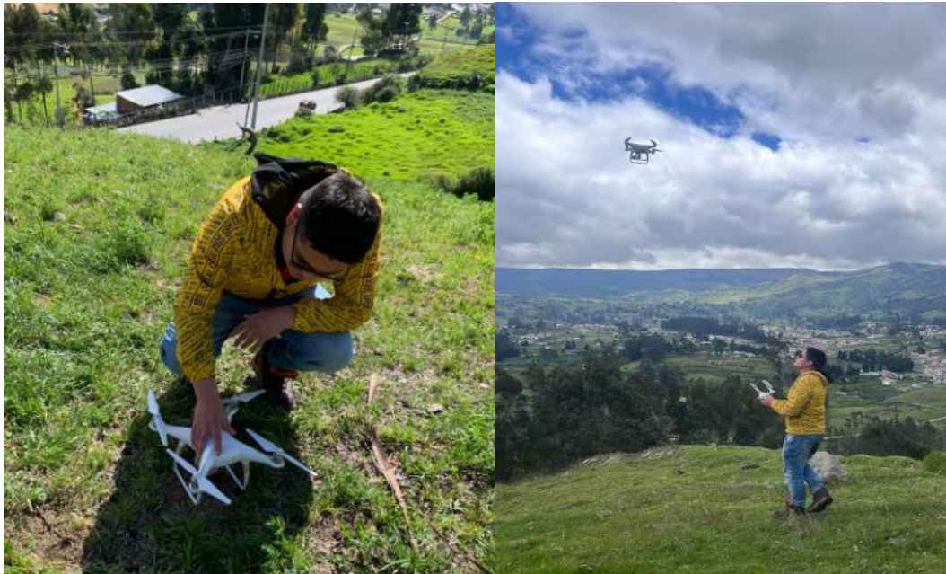
Figura 3. 12 Ejecución del plan de vuelo para el levantamiento topográfico con dron de la zona que se va realizar el levantamiento. Elaboración propia.
