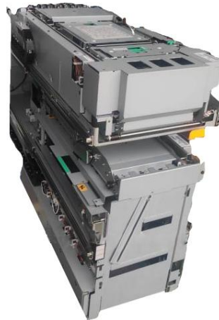
Figura 2.4 Reciclador de efectivo de un cajero NCR 6687
