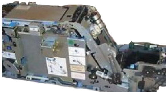
Figura 2.5 Depositario de cheques de un cajero Diebold Nextgen 3700
