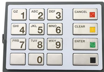
Figura 2.6 Teclado electrónico de un cajero Diebold Opteva 520
