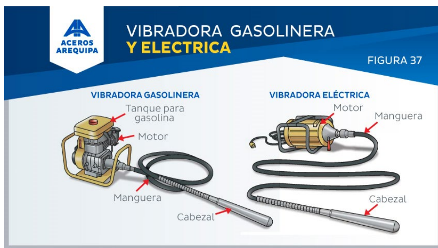
Figura 32 Gráfica representativa de tipos de vibrador para concreto.
