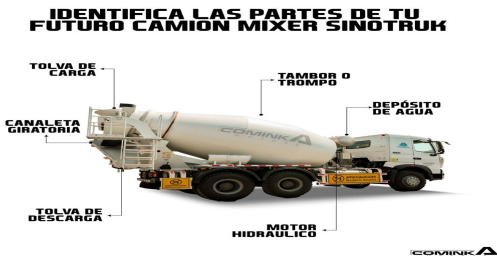
Figura 30 Gráfica representativa de las partes de un camión Mixer.
