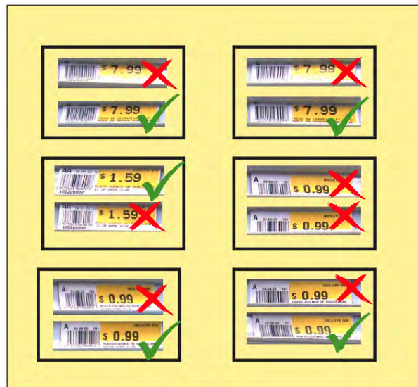
Figura 3.12: Visualización de la selección de las etiquetas de precio por cada cluster generado escogiendo las mejor de todas. En caso de no haber alguna etiqueta que supere las cotas mínimas definidas, no se seleccionará etiqueta de ese cluster.
