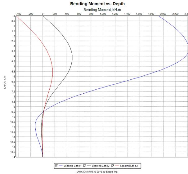
**Figura 5.27 Comportamiento de Momentos pilote de 14 m. Fuente: LPile**
