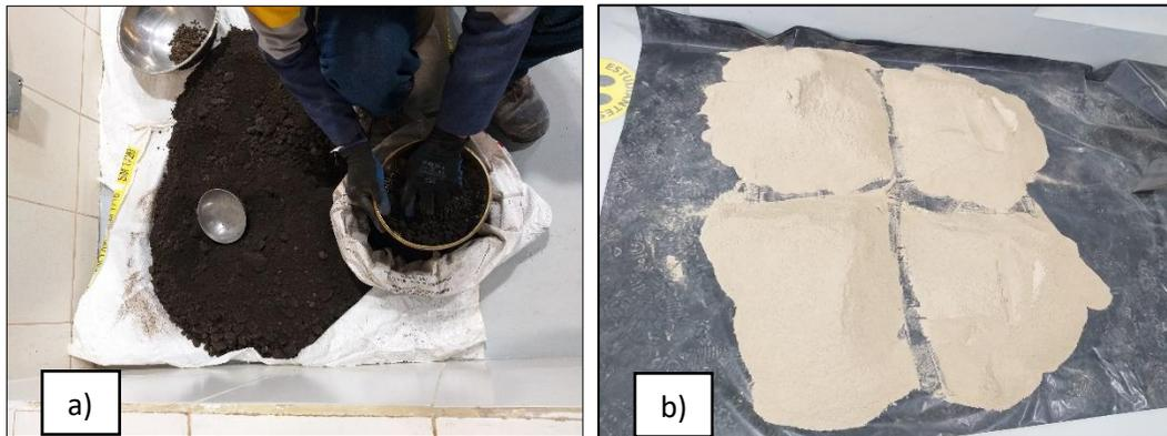
Fig. 4. a y b) Reducción de material a tamaño de ensayo
