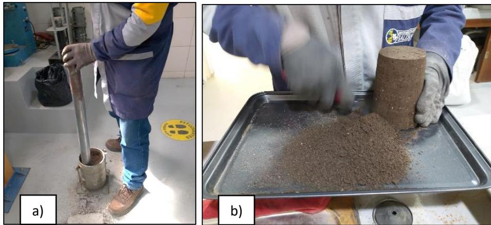
Fig. 10. a) Compactación suelo-cemento, b) Probetas para compresión no confinada
