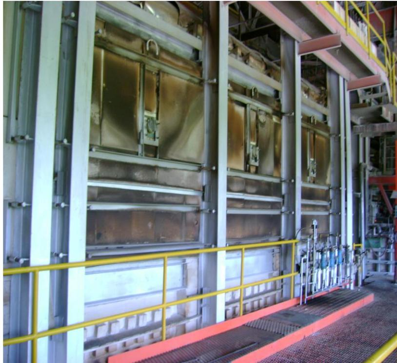
**FIGURA 2.8 HORNO DE MATERIALES REFRACTARIOS.**
