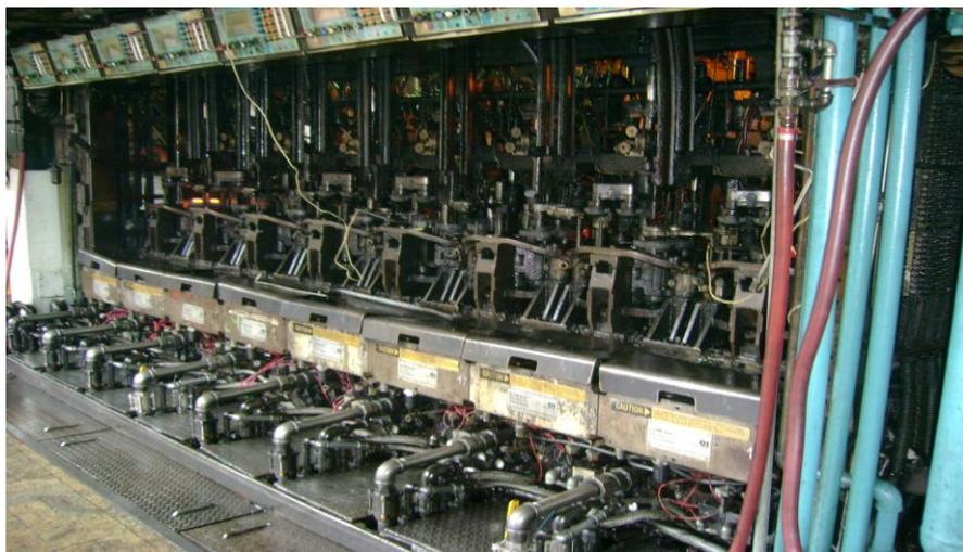
**FIGURA 2.10 MÁQUINAS DE SECCIÓN INDEPENDIENTE PARA LA FORMACIÓN DE BOTELLAS.**
