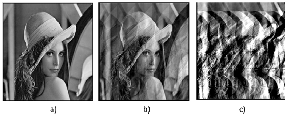
Figura 3.5 Restauración de Imágenes a) Imagen original, b) imagen restaurada con n = 30 c) imagen restaurada con n = 40
