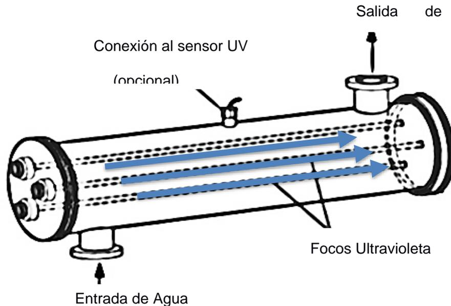
Los elementos fundamentales del sistema de desinfección mediante luz ultravioleta (UV) incluyen las lámparas de vapor de mercurio, el reactor y los balastos electrónicos. La fuente lumínica UV proviene de las lámparas de arco de mercurio de baja o mediana presión, ya sea con una intensidad lumínica baja o alta (Pure Water.co, 2023).
