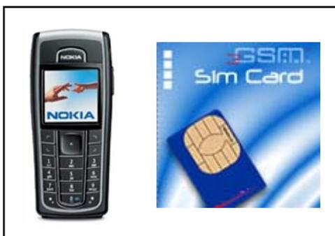
**FIGURA No 2.2: Estación móvil GSM con SIM card.**
