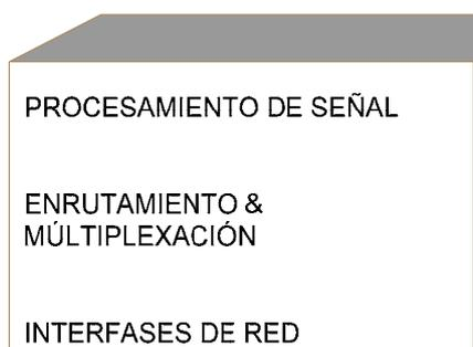
**FIGURA No 3.6 Funciones principales de un Multimedia Gateway**
