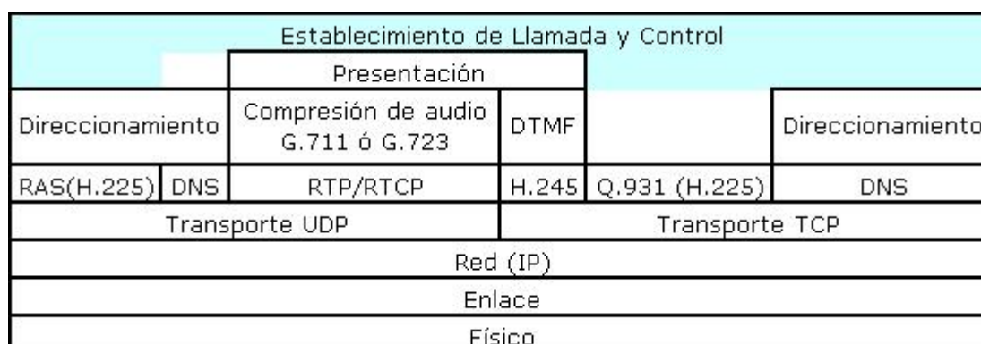
Fig. 2.1 Arquitectura de protocolos VoIP
