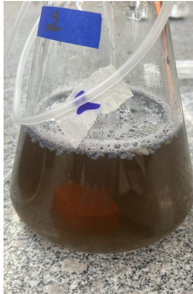
Figura 3.10 Contaminación de reactor 2 de escalado a 1.6 L
