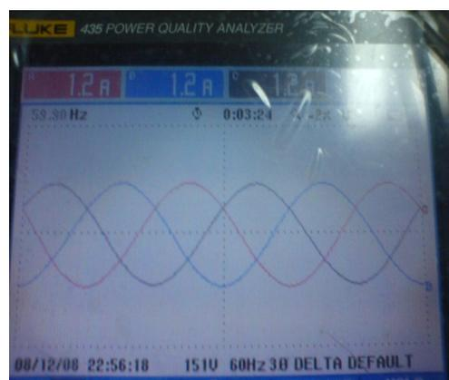
Figura 14: Corriente AC Trifásico en la Carga
