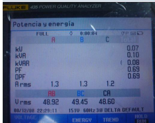
**Figura 15:** Potencias y Factor de Potencia Trifásica en la Carga
