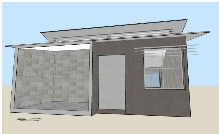
Figura 3.18 Instalación de persianas exteriores y vidriado hermético en ventanas
