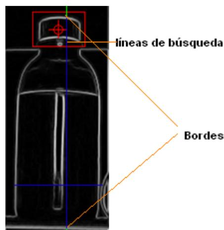
Figura 27. Detección de Borde en botella tipo A
