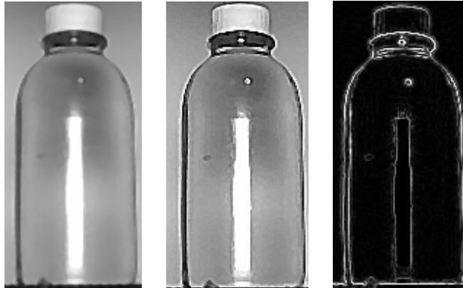
Figura 29. Contraste del Borde a diferente iluminación
