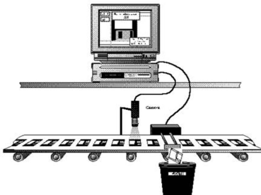
Figura 4. Sistema de Visión basado en PC
