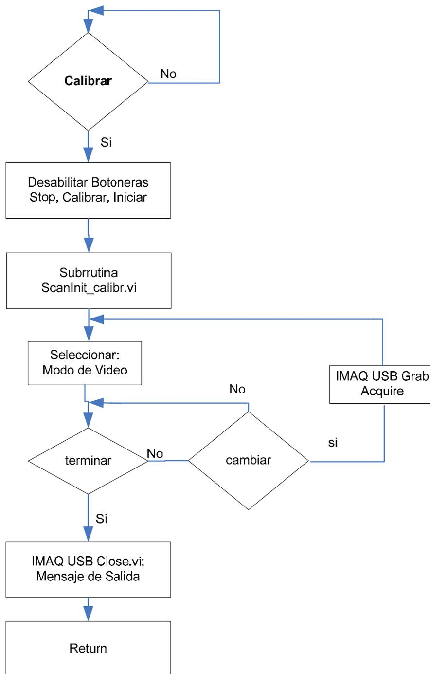
**DIAGRAMA DE FLUJO DE CALIBRACIÓN DE CÁMARA**
