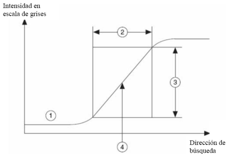
Figura 28. Modelo del Borde. 1) Modelo en la escala de Grises, 2) Ancho del Borde, 3) Fuerza del Borde, 4) Ubicación del Borde
