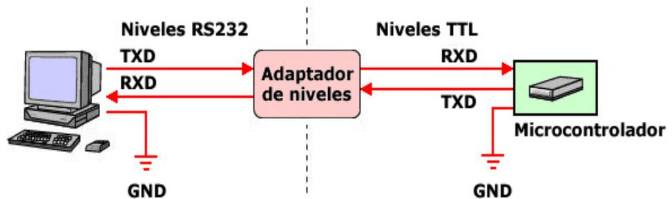
Figura 32. Conexión Microcontrolador - CPU
