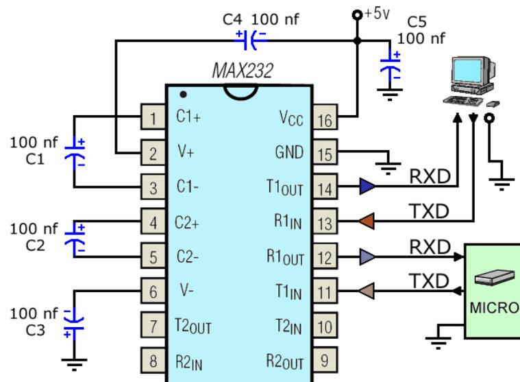
Conexión de un microcontrolador con un PC mediante MAX232. Con los condensadores de 100 nF se puede llegar hasta los 64 Kbps, si se colocan condensadores de 1  $\mu$ F se puede llegar hasta 120 Kbps
