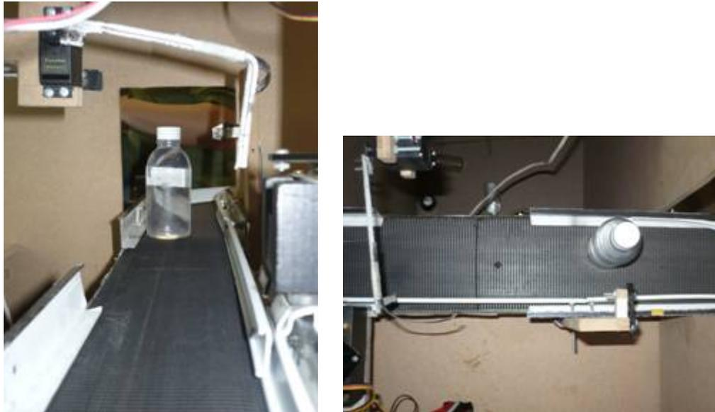
Figura 24. Ingreso del Frasco y Detección del Sensor
