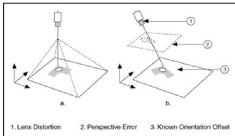
Figura 14. Posicionamiento de la Cámara
