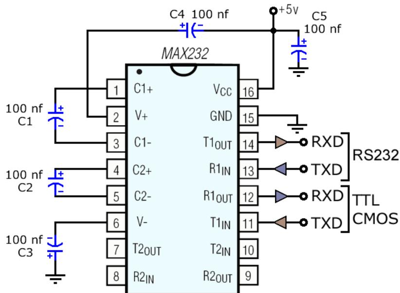
Conexión mínima RS232/TTL con un MAX232. Con los condensadores de 100 nF se puede llegar hasta los 64 Kbps, si se colocan de 1  $\mu$ F se puede llegar hasta 120 Kbps
