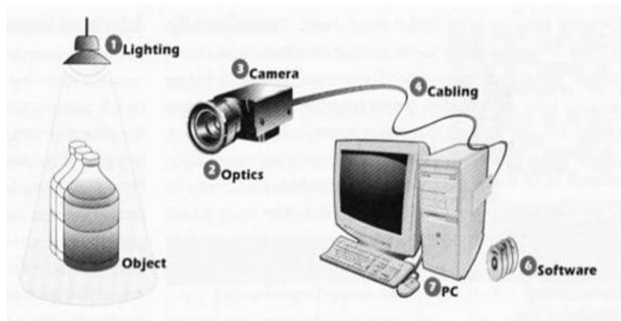
Figura 5. Componentes para un Sistema de Visión
