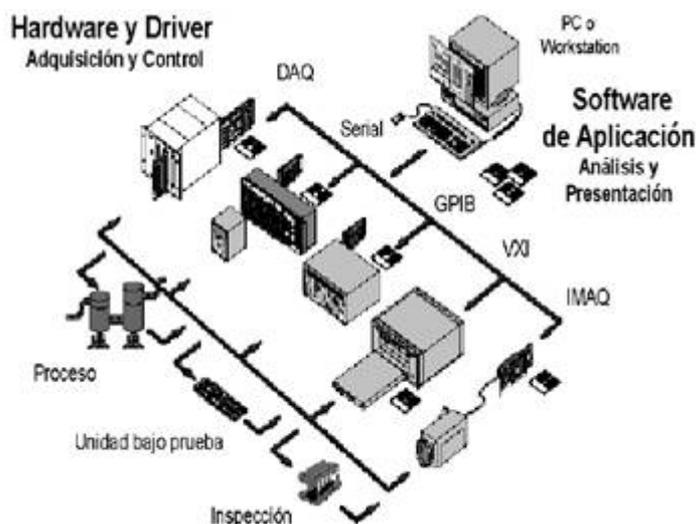
Figura 2. Modelo de un Sistema con Instrumentación Virtual
