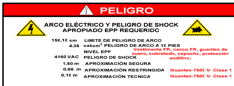
Figura 7.2. Etiqueta de seguridad requerida en el panel principal donde se realizó el análisis de la falla 1 en el capítulo 4 literal 4.5.
