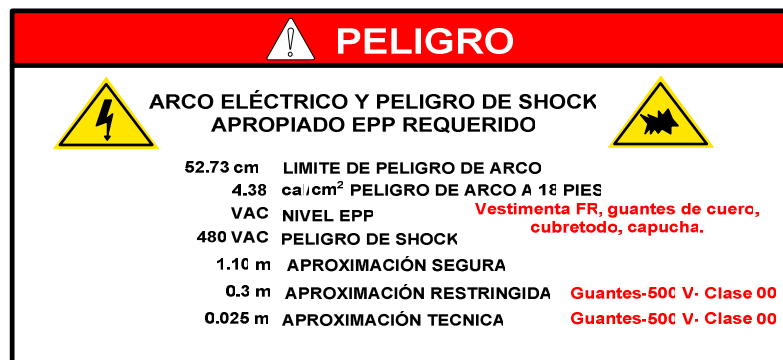
Figura 7.4. Etiqueta de seguridad requerida en el panel de torres de enfriamiento donde se realizó el análisis de la falla 3 en el capítulo 4 literal 4.5.
