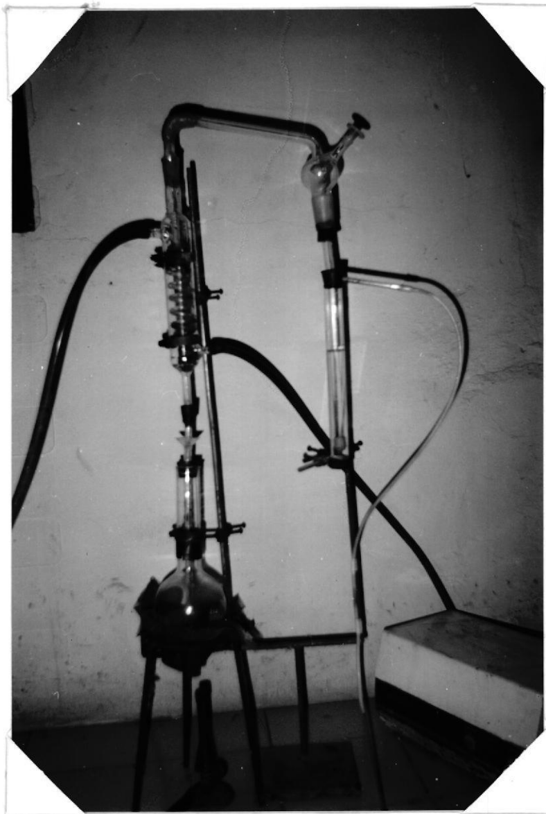
FOTO #4: Aparato de destilación para determinación de cianuro.
