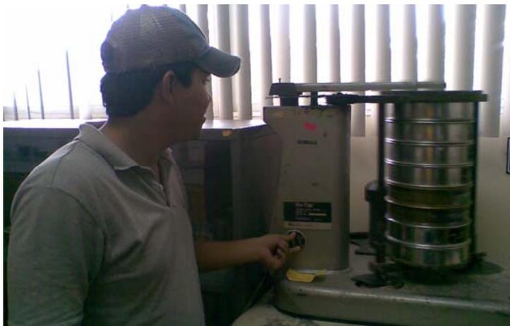
FIGURA 3.10 PROCESO DEL TERCER TAMIZADO
