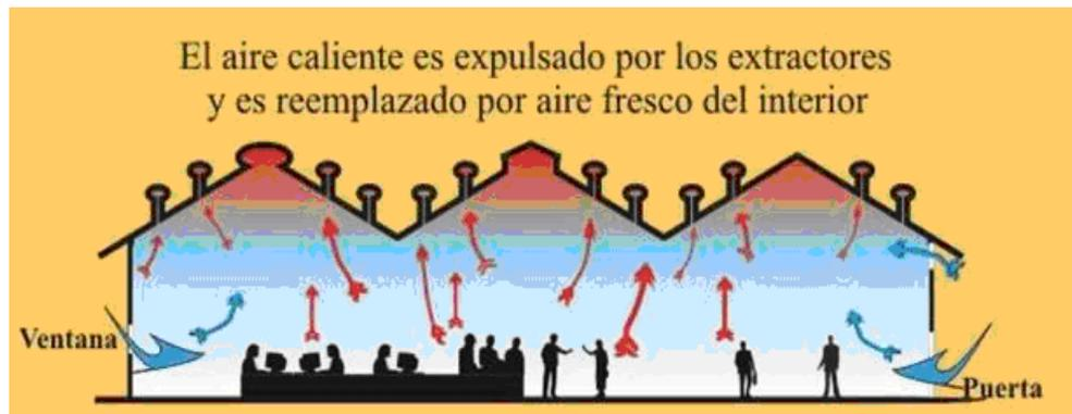
**FIGURA 2.11 FUNCIÓN QUE REALIZA UN EXTRACTOR EÓLICO**
