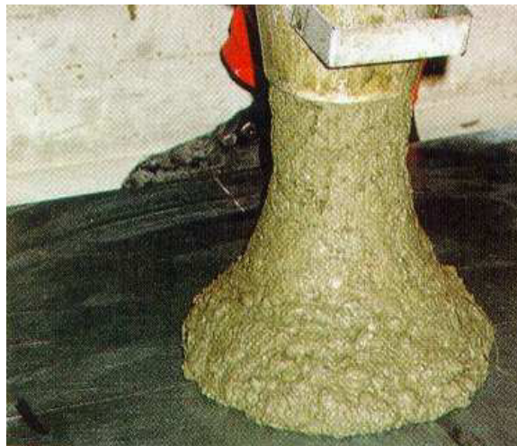
FIGURA 2.7 USO DEL CONO DE ABRAMS EN PRUEBA DE FLUJO LIBRE
