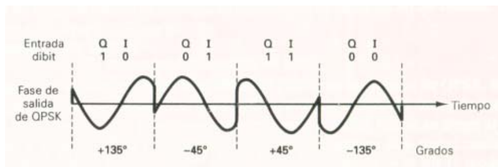
Figura 3.4 Relación de la fase de salida contra tiempo para un modulador
